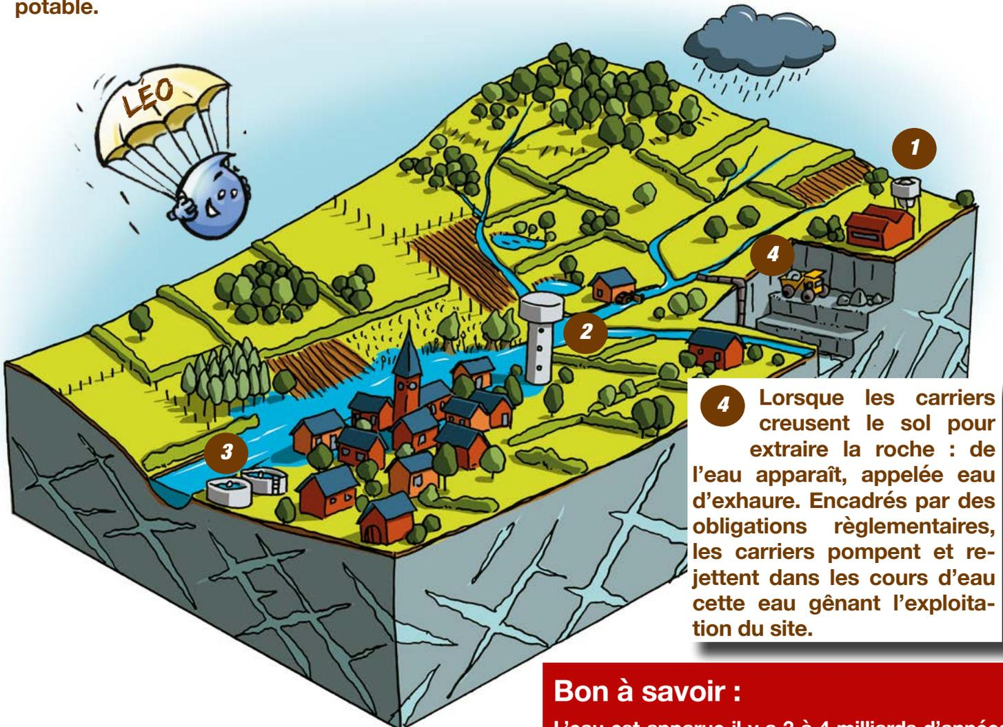
**4** Lorsque les carriers creusent le sol pour extraire la roche : de l'eau apparaît, appelée eau d'exhaure. Encadrés par des obligations réglementaires, les carriers pompent et rejettent dans les cours d'eau cette eau gênant l'exploitation du site.
