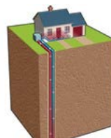
Géothermie de surface verticale © Géothermie Soutz
